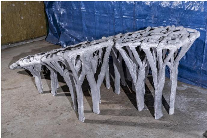
Technologie par extrusion
