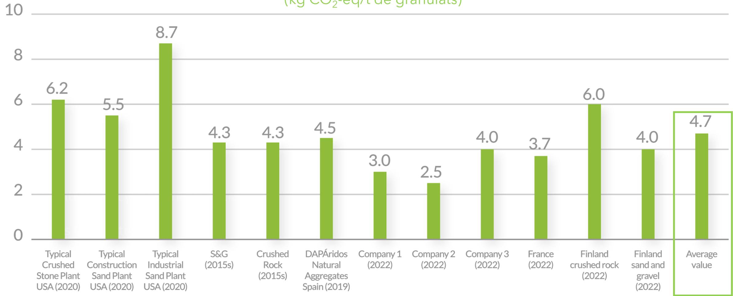
**Émissions d'équivalent CO<sub>2</sub> pour les granulats naturels, recyclés, et artificiels**
