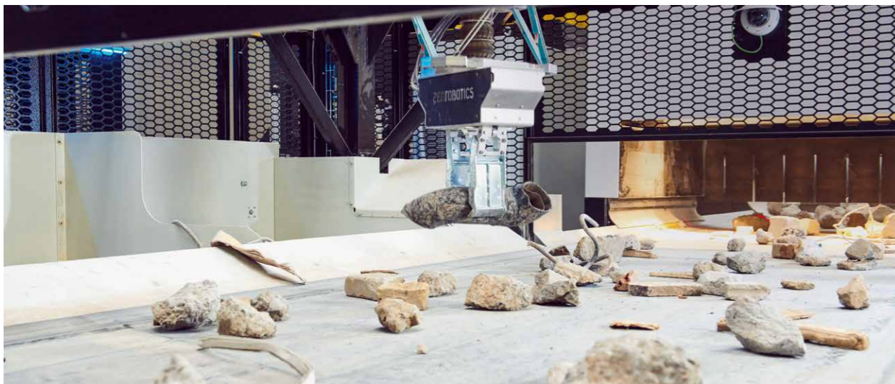
Grâce à un traitement de haute qualité à l'aide de robots, les matériaux de construction minéraux sont maintenus plusieurs fois dans le circuit.
