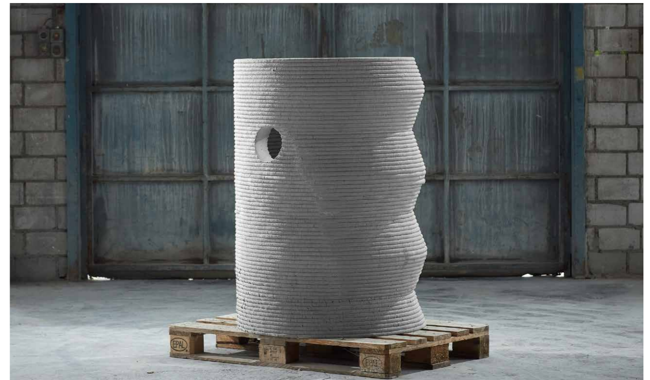
Prototype d'une structure fabriquée par une imprimante à béton 3D
