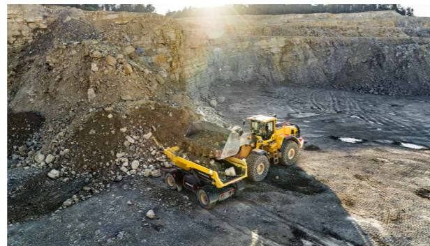
Tests de dumpers électriques autonomes dans la carrière d'une cimenterie à Siggenthal (AG)
