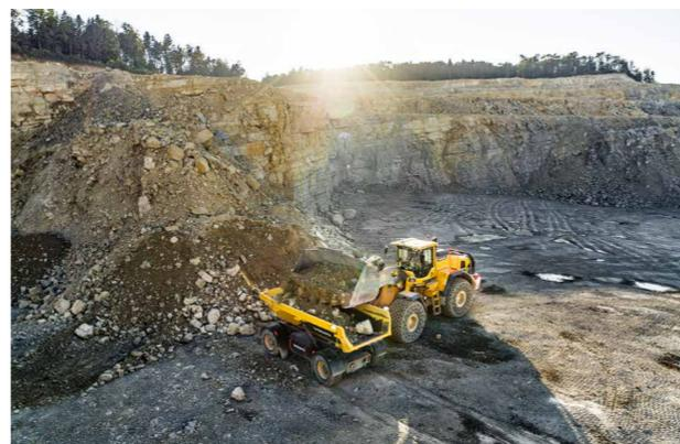
Fast geräuschlos, abgasfrei und sicher: Tests mit autonomen E-Dumpfern im Steinbruch eines Zementwerks in Siggenthal (AG)
