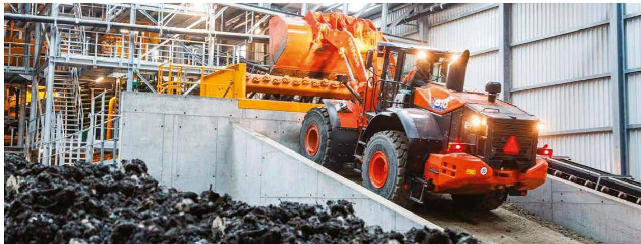
Das Beschicken einer Waschanlage mittels Pneulader
