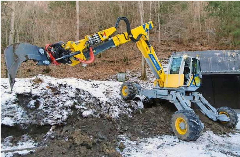
Bei den Grabarbeiten beim Eingang der ehemaligen Munitionsanlage kommen die Vorteile des geländegängigen „Armano“ zur Geltung.
