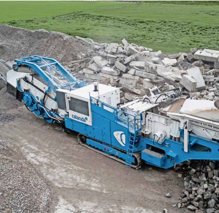
Raupenmobile Prallbrechanlage mit Siebeinheit.
