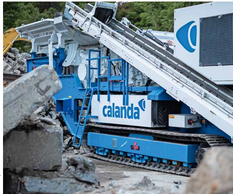
Mit der neuen Hydrauliklösung werden die Nebenantriebe wie Rinnen, Siebe und Förderbänder verbrauchsoptimiert angetrieben.
