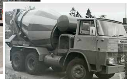
Erster Liebherr-Fahrmischer von 1967, ein HTM 601 auf einem Henschel-Fahrgestell.
