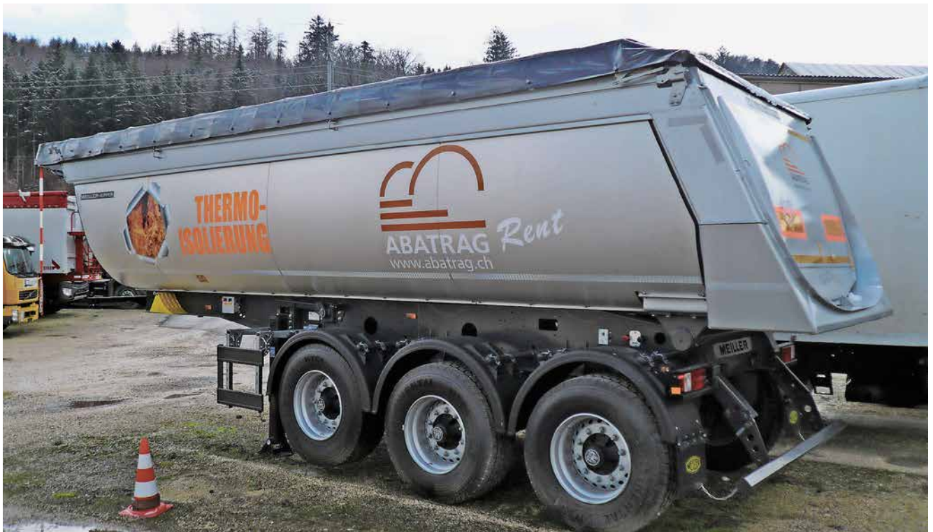
Aus dem Meiller-Programm für Baustellen- und Massentransporte wird der Kippsattelaufleger MHPS 44/3 mit vorderer Liftachse und isolierter Stahl-Rundmulde für den Asphalttransport gezeigt.
