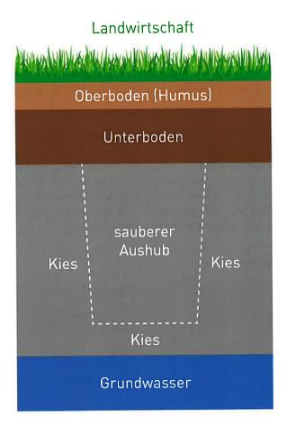
Während dem Kiesabbau wird eine mindestens zwei Meter mächtige Kiesschicht zum Schutz des Grundwassers belassen. Der Boden wird während dem Abbau gelagert und nach dem Abbau gemäss FSKB-Richtlinien wieder aufgetragen.
